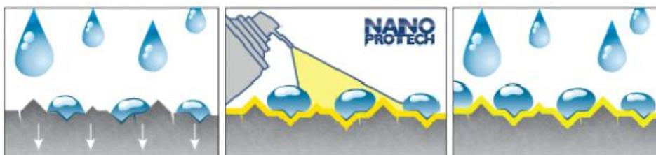
**Čištění:** - po první aplikaci se nanočástice dostávají do struktury materiálu (mikrotrhliny), odkud vytěsní od povrchu materiálu veškeré povýstřelové zplodiny (měď, zinek, olovo, karbon...). Následně vytvoří neviditelný film nanočástic, který dlouhodobě tyto nečistoty odpuzuje, a tak se velmi snadno odstraní mechanicky.
